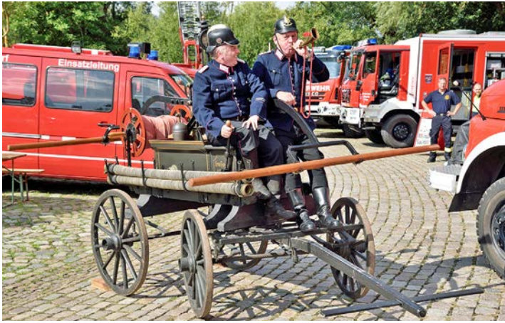
Zur modernen Technik der Kameraden zählte anno dazumal eine Saug- und Druckspritze (hier beim Plöner Blaulichttag 2018), die von Pferden an den Brandort gezogen werden musste
